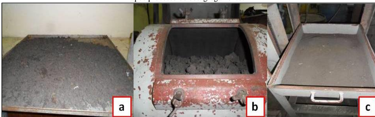
Figura 7. Processo de moagem da massa seca do lodo: a)antes do desagragamento; b)Moinho de bolas; c)Lodo após processo de desagregamento.
